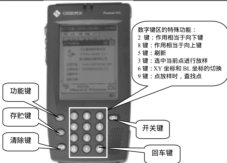
图 7-2 CASIO 正面外部结构图
